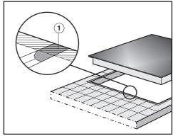
Стыки ① и заштрихованная область под поверхностью элемента SmartLine должны быть гладкими и ровными, чтобы элемент лежал ровно и уплотнение под кромкой верхней части прибора обеспечивало герметизацию столешницы.
