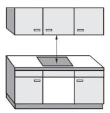
Между элементом SmartLine и расположенной над ней кухонной вытяжкой должно быть соблюдено безопасное расстояние, указанное производителем вытяжки.
