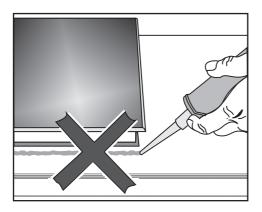
Элемент SmartLine и столешница могут получить повреждения при возможно необходимом демонтаже элемента, если уплотнять его с применением герметика. Не используйте герметик для уплотнения между элементом SmartLine и столешницей. Уплотнение под краем верхней части панели обеспечивает достаточную герметизацию столешницы.
